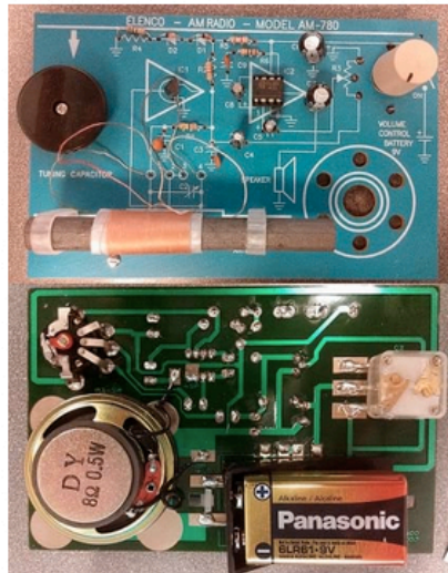
An assembled Elenco AM radio kit.
